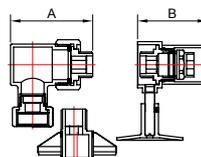
**Комплект для п/с с эксцентриком и отражателем**
